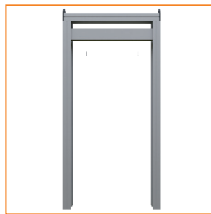
3. Fissare la guida superiore nella predisposizione monoblocco 85
