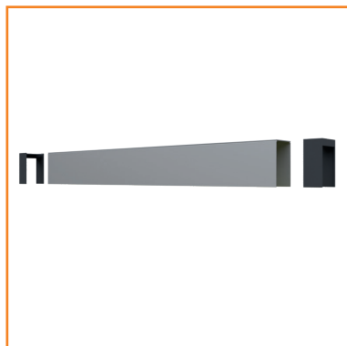
1. Inserire le cuffie telescopiche nella guida superiore
