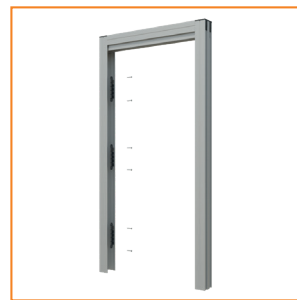
4. Fissare le clips nella predisposizione incasso dal lato in cui si vuole impacchettare la zanzariera facendo attenzione che siano allineate verticalmente tra di loro
