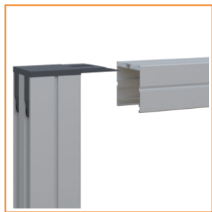
1. Inserire gli angolari di accoppiamento (gli angolari dovranno aderire alle altezze dei profili incasso) come da foto
