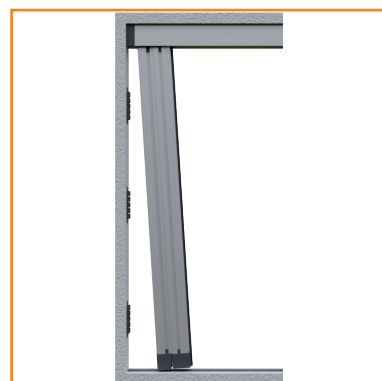
6. Inserire i corpi zanzariera nella guida superiore e farli agganciare alle clips esercitando una leggera pressione. Attenzione! La parte superiore delle zanzariere è quella con la dicitura UPSIDE sul tappo (vedi particolare 1)
