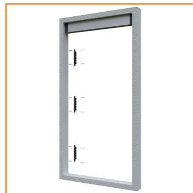
3. Fissare le clips sul vano dal lato in cui si vuole impacchettare la zanzariera facendo attenzione che siano allineate verticalmente tra di loro
