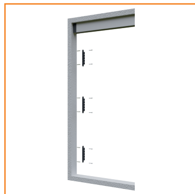
3. Fissare le clips sul vano in entrambi i lati facendo attenzione che siano allineate verticalmente tra di loro
