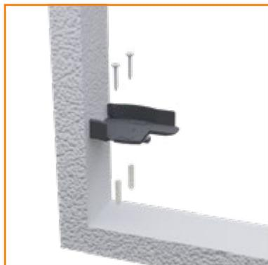
1. Fissare le testate a muro inferiori e superiori
