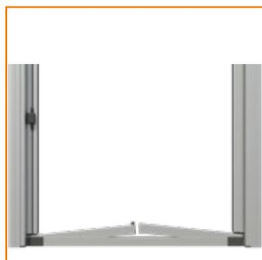
7. Inserire le guide spazzolino inferiori nella guida registrabile. Fare attenzione a inserire la guida con il gancio sul lato semifisso e con l'aletta rivolta verso l'esterno (vedi particolare I)
