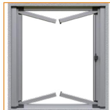
6. Inserire la guide spazzolino superiori e inferiori nelle guide registrabili. Fare attenzione a inserire le guide con i ganci sul lato semifisso e con le alette rivolte verso l'esterno (vedi particolare 2) In presenza di fuori squadra, effettuare le operazioni di registrazione delle guide spazzolino
