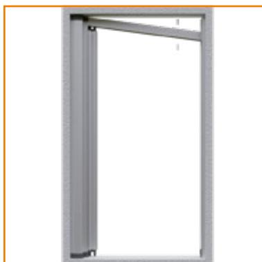
5. Inserire la guida registrabile superiore all'interno della feritoia del cassonetto e nell'invito testata a muro (vedi particolare 2). Fissare al vano
