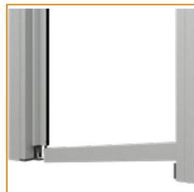
6. Inserire la guida spazzolino inferiore nella linguetta di collegamento guida e nel blocco guida del riscontro incasso magnetico.
