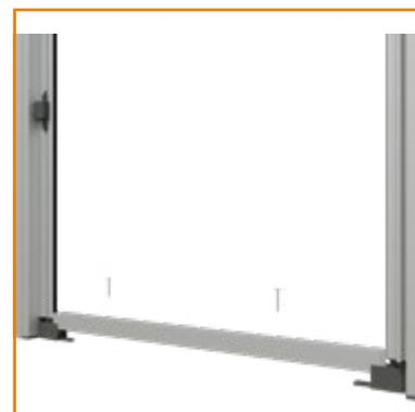
6. Inserire la guida registrabile inferiore all'interno delle feritoie degli innesti porta guida. Fissare al vano
